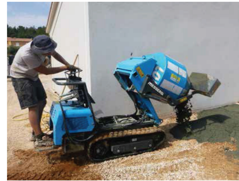
Stavební míchačka, míchaný objem 180 l
