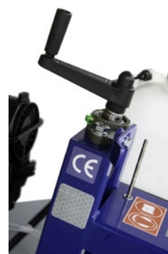
Spouštění kotouče do řezu a ukazatel
