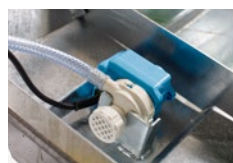
Čerpadlo chladicí vody
