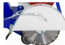
Přívod vody do krytu kotouče
