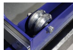
Zatěsněné kladky pojezdu stolu
