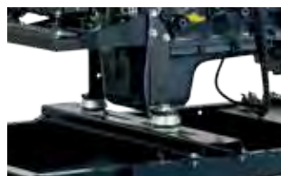
Uchycení na silentbločích pro těžký provoz
