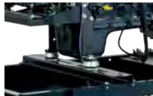
Uchycení na silentbločích pro těžký provoz
