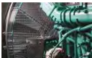
Pohyblivé a rotující díly chráněny před nechtěným dotykem
