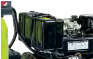
Nahoře umístěná kovová palivová nádrž (GBA7, GBA12)
