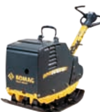
BPR 55/65 D Provozní hmotnost: 450 kg Odstředivá síla: 55 kN Pracovní šířka: 650 mm
