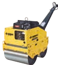
BW 75 H Provozní hmotnost: 1 040 kg Odstředivá síla: 40 kN Pracovní šířka: 750 mm
