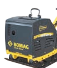
BPR 100/80 D Provozní hmotnost: 710 kg Odstředivá síla: 100 kN Pracovní šířka: 800 mm
